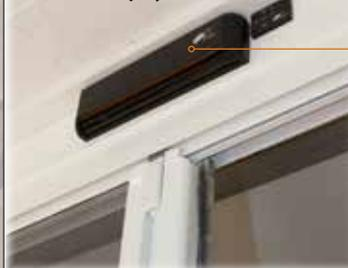
Il sensore ci vede arrivare ed apre la zanzariera, mentre il display ci indica sempre quali funzioni sono attive (sensore attivo, sensore non attivo, ecc.), proprio come una porta automatica.
